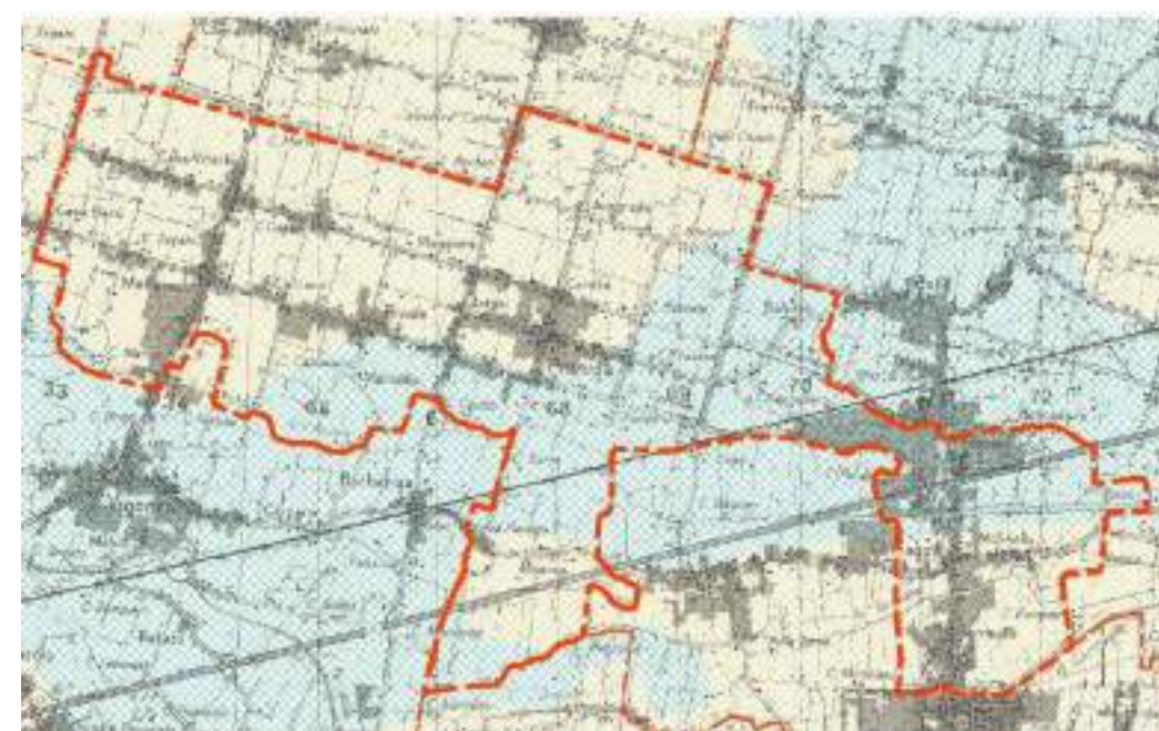
Permeabilità dei terreni: in giallo terreni con discreta permeabilità, in azzurro terreni poco permeabili in grigio aree impermeabilizzate.
